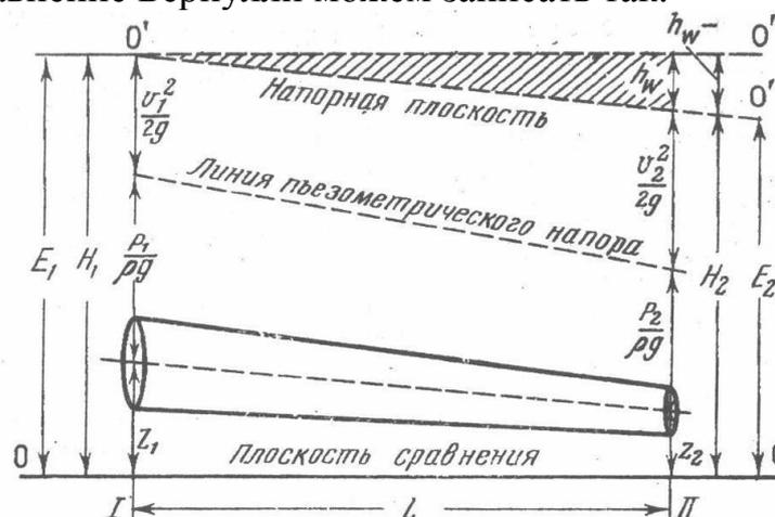
**Рис. 3.4.2.3 Уравнение Д.Бернулли для струйки вязкой жидкости**
