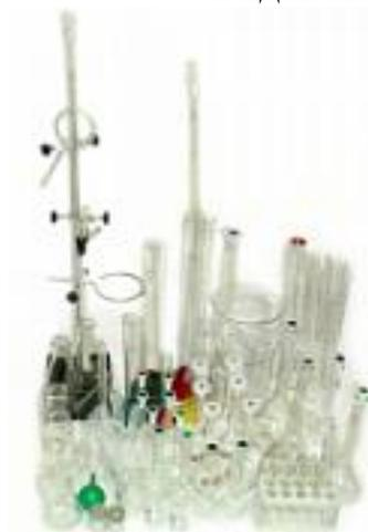
Набор посуды для химического анализа многофункциональный предназначен для отбора, точного измерения и дозирования объемов различных растворов и жидкостей, приготовления растворов, фильтрования суспензий и взвесей, титрования в ходе проведения химических анализов и подготовки к ним в лабораторных условиях.
